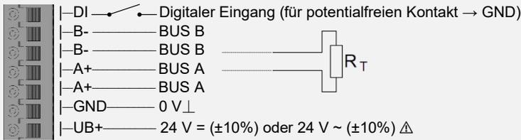
Bei Wechsellspannung muss auf korrekte Polung geachtet werden!
