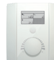
NOVOS 3 INC LoRaWAN Panel de usuario con codificador incremental
